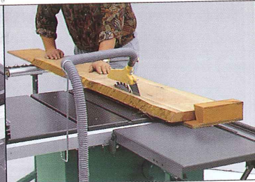
Exaktes und einfaches Besäumen wie an Großmaschinen in allen Längen
