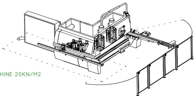
STAT.BELASTUNG IM BEREICH DER MASCHINE 20KN/M2
